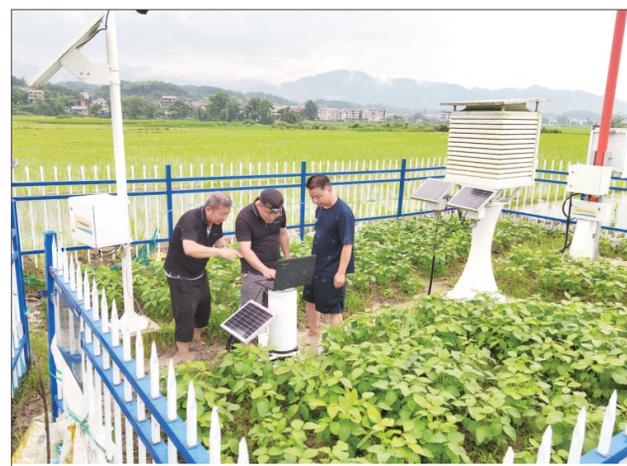
6月19日,绥宁县气象局组织3名检修人员来到武阳镇智能气象站更换雨量传感器,检修百叶箱、风向风速、温度湿度、气压监测设备,将精准数据上传给防汛抗旱指挥部,为该县防汛工作提供精确数据保障。
