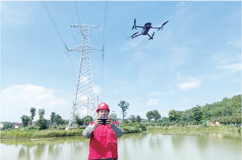
飞手操控无人机对复合绝缘子进行红外测温。
