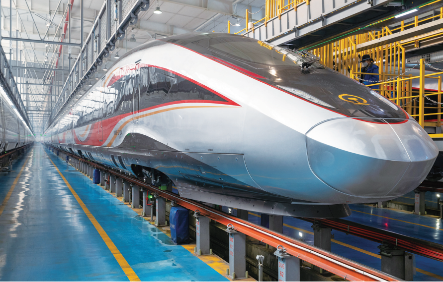
图为停靠在中国铁路哈尔滨局集团有限公司哈尔滨动车段检修车间内的CR400BF-GZ型复兴号高寒智能动车组(1月16日摄)。
