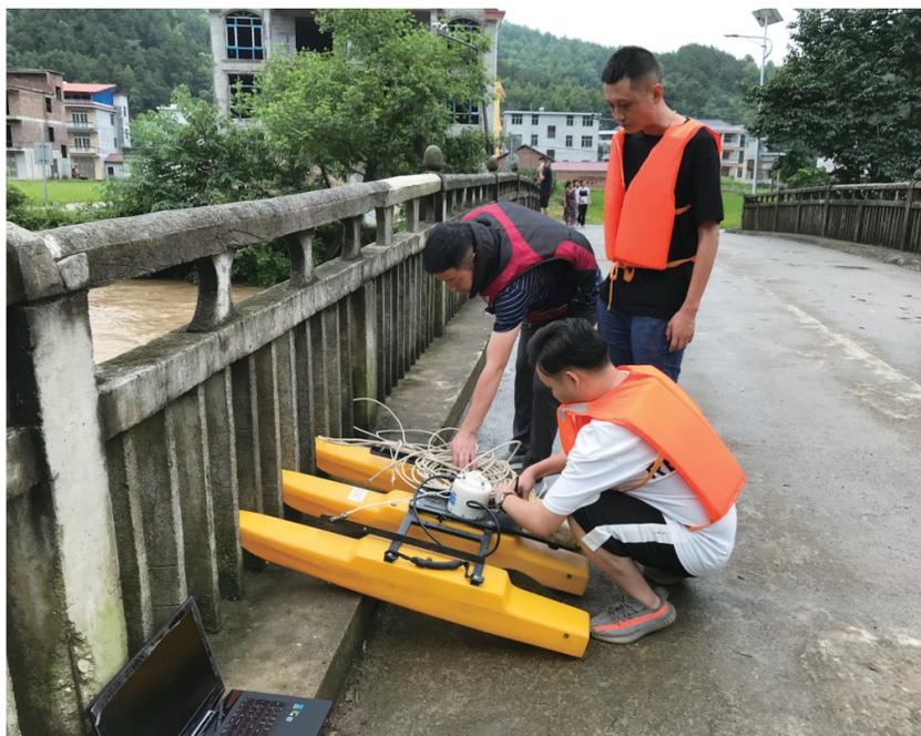
7月4日上午,邵阳水文中心应急监测队在官桥站使用ADCP(声学多普勒流速剖面仪)测流。
