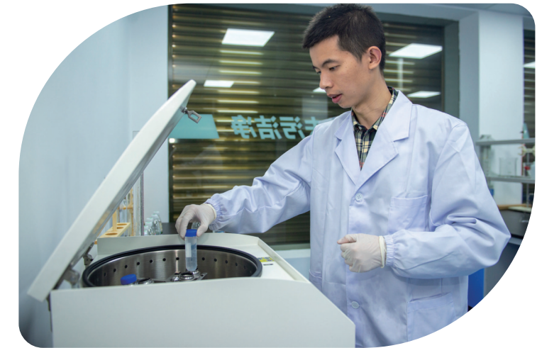
▲市水质检测中心样品预处理区,工作人员操作离心机,对污水样品中的水、泥及杂质进行指标测试。
