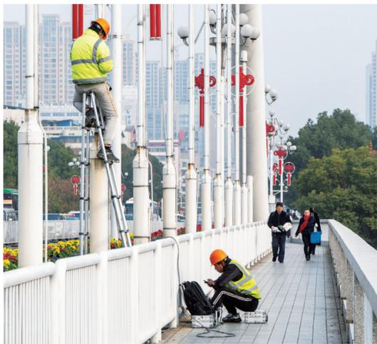
专业人员操作仪器,通过磁致伸缩导波无损检测法对各吊杆进行精准的数据采集。
