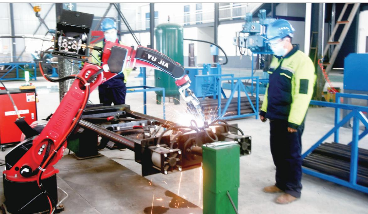
位于新邵经开区的潇龙机械设备制造有限公司，主要生产封边机、烫印机和封边烫印一体机。日前，该公司总投资约1亿元的二期项目竣工投产，预计可使该公司年产值达到2亿元，并解决300余人的劳动就业问题。图为该公司车间内的机器人正在进行焊接作业。邵阳日报记者 杨敏华 通讯员 何雯 摄影报道
