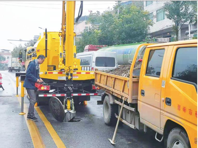
12月3日上午,大祥区宝庆西路上,市市政工程总公司新投入使用的多功能挖掘式管道疏通车正在作业。这台车配置新型专用挖掘器,具备牵引绳穿管功能,能够轻松应对各类复杂施工状况,快速疏通排水管道内的顽固淤塞,清淤率可达90%。同时,备有高压冲水系统,能够通过冲洗解决管道淤塞问题。邵阳日报记者 宁如娟 通讯员 张梅 摄影报道
