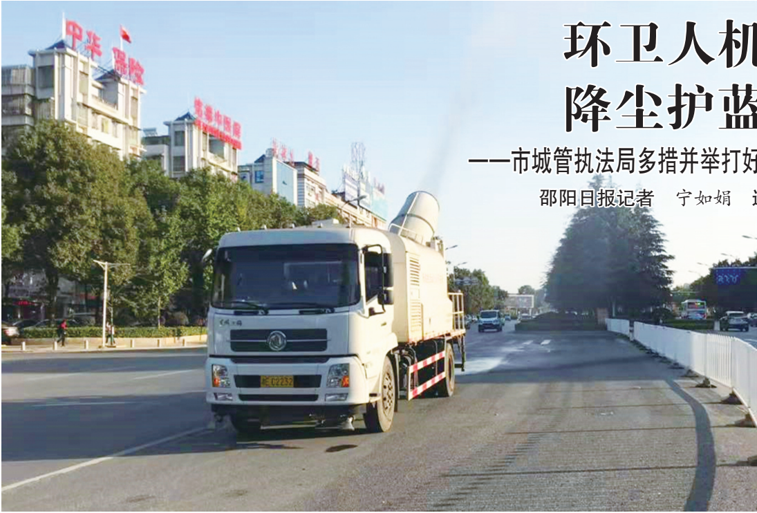
▲雾炮车作业降尘。
