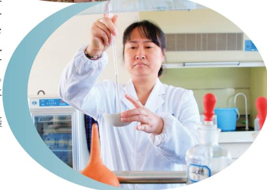
▲洋溪桥污水处理厂工作人员对出厂的水进行COD、总磷、氨氮等12项检测。
