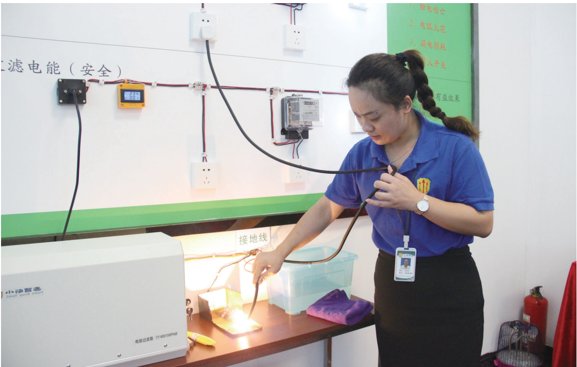
工作人员现场演示电能过滤器的防触电功能。
