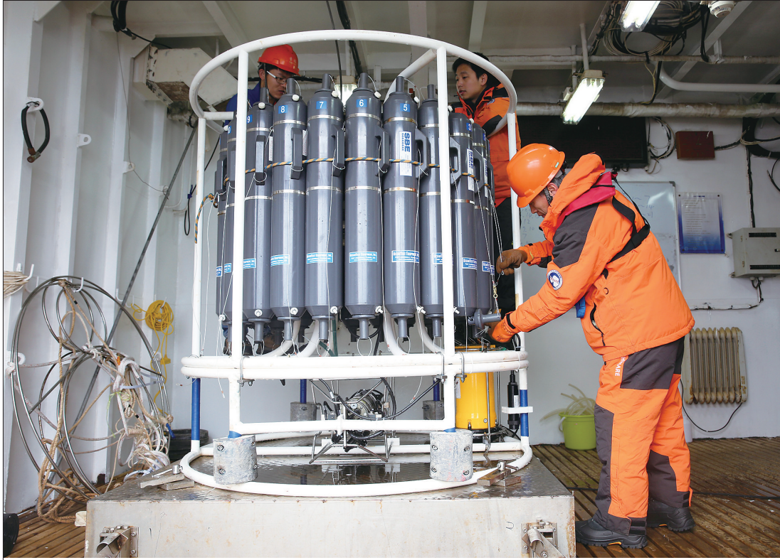
1月28日，中国南极科考队员在“雪龙”号实验室内对即将布放到南极罗斯海中的CTD温盐深剖面仪进行最后的调试。 当日，中国第34次南极科考队在南极罗斯海围绕海洋微塑料、人工放射性核素、海洋保护区等展开业务化观测。 新华社发(郭松桥摄)
