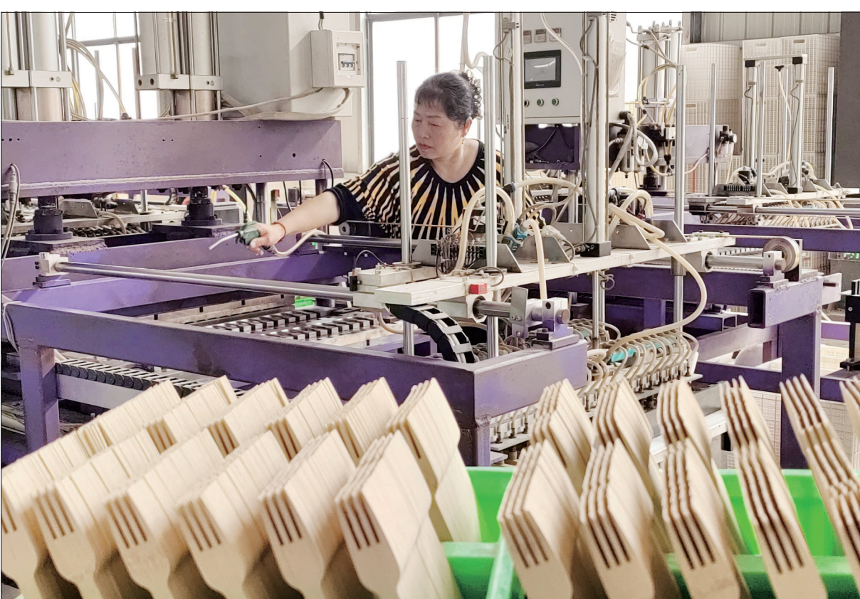
4月11日,城步产业开发区茅坪湘商产业园湖南南山金竹生态科技有限公司,员工忙着给竹制叉勺热压成形生产线除尘。今年来,城步苗族自治县外贸出口来势不断向好,已接到各类竹制西式餐具订单600多万美元,眼下各企业正提升产能、“火力”全开,确保按期交货。 严钦龙 摄
