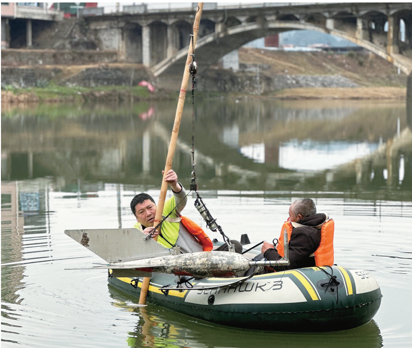
水文职工正在开展水深测量和缆道起点距核准工作。
