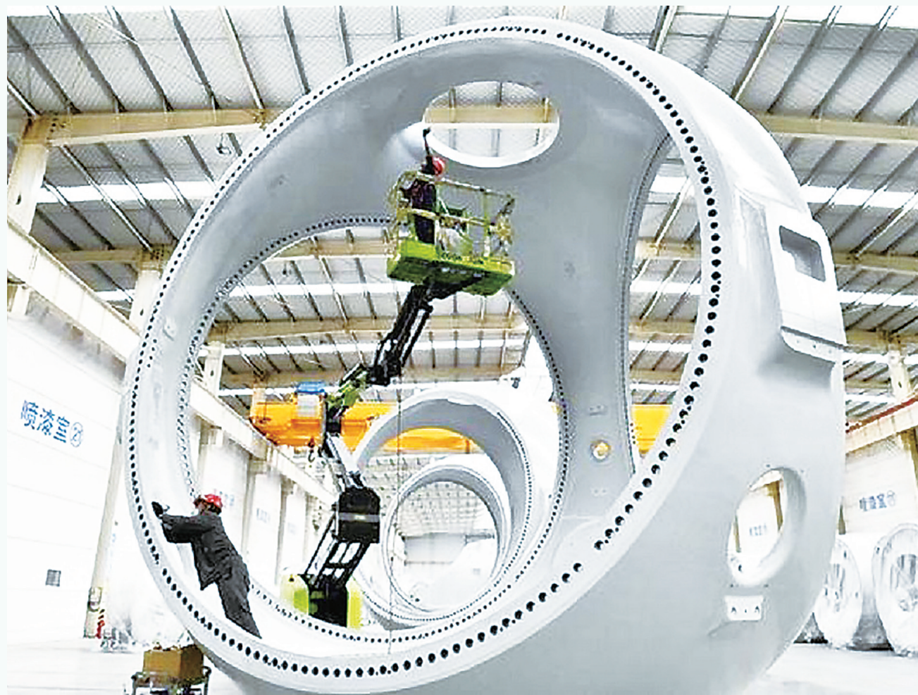
在山东省惠民县风电装备产业基地涂装车间,工作人员对风电轮毂进行涂装。 新华社记者 郭绪雷 摄
