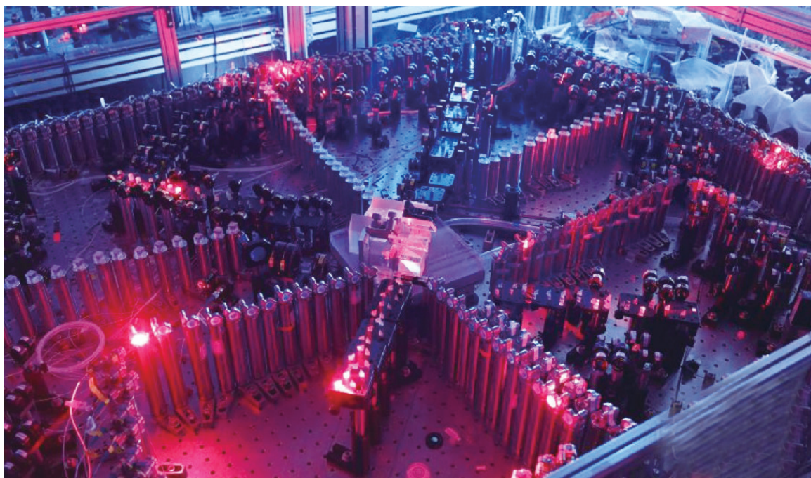
▲这是光子干涉实物图:左下方为输入光学部分,右下方为锁相光路,上方共输出100个光学模式,分别通过低损耗单模光纤与100超导单光子探测器连接。 新华社发
