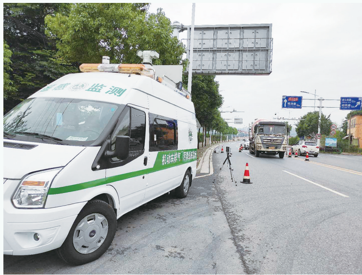
不达标车辆。机动车排放污染遥感监测车上路,稽查尾气排放
