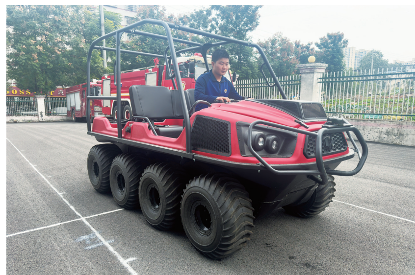
12月8日,大祥区消防救援大队消防员在展示新装备——消防水陆两栖全地形车。该车搭载专业消防设备,行驶中能迅速展开灭火、救援;配备先进的通信系统,可确保复杂环境下与指挥中心顺畅沟通;可在陆地上驰骋,也能在水里“乘风破浪”,是运送物资、转移被困人员的最佳帮手。 肖远 唐准 摄影报道
