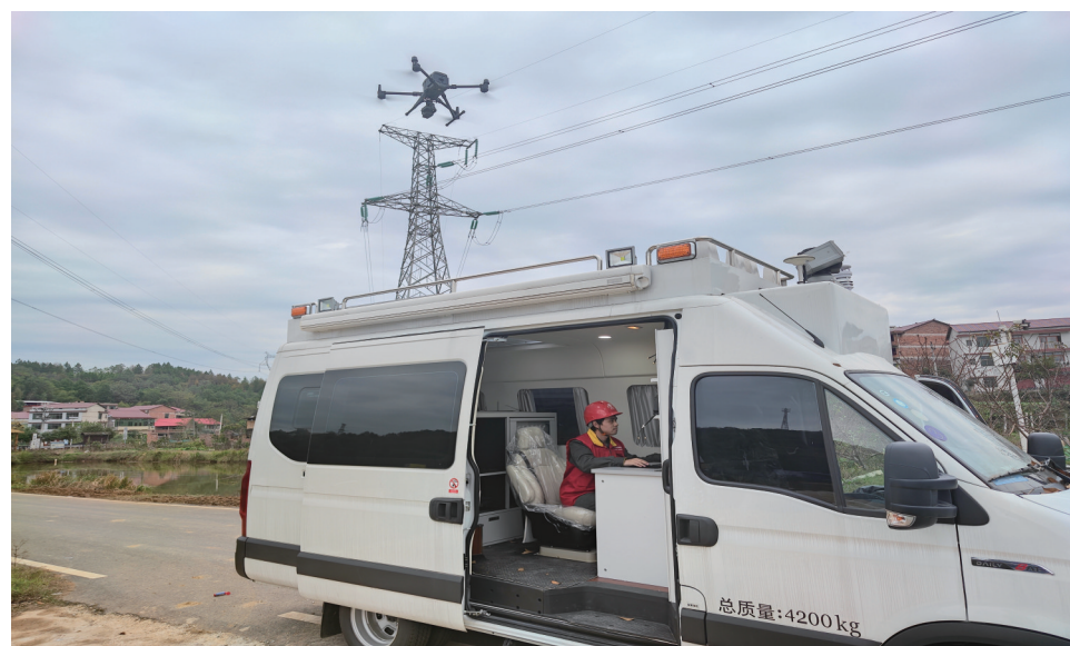
供电公司工作人员在无人机移动作业车内操控无人机进行线路巡视。
