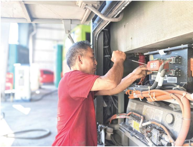
胡风云打开车辆后机舱盖准备检查电机等重点部位。王秀丽 摄
