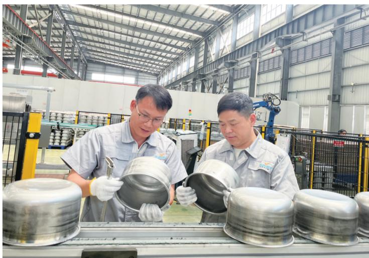
章新主(右)和同事对刚下线的电饭煲内胆进行随机检查。
