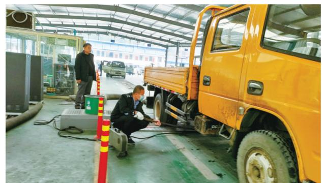
10月23日,绥宁县湘军机动车检测中心,工作人员正在对一台货车进行尾气达标检测。该中心现有机动车排放污染物参数检测线3条、机动车安全性能检测线2条、摩托车安全性能检测线1条,可对机动车进行环保尾气检测、年检、综检等一站式快捷检测业务,特别是摩托车安全性能检测线,开全县之先河。
