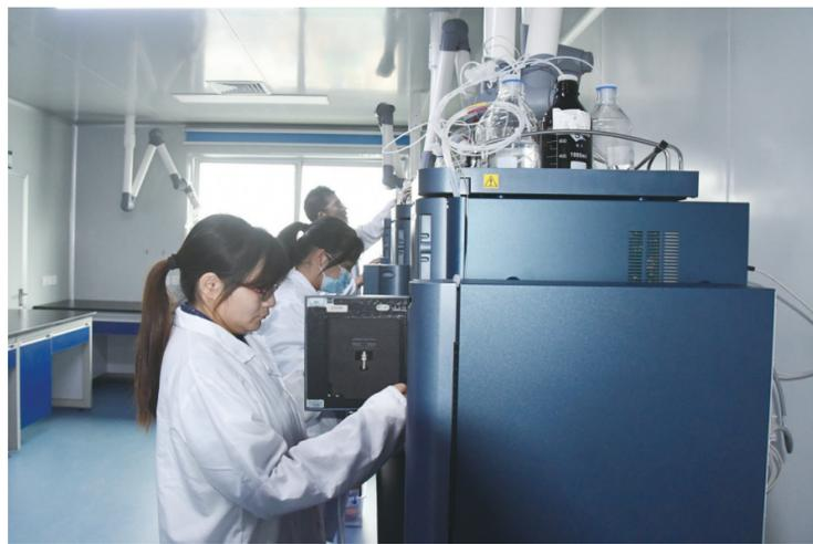
▲科瑞生物质检部检验人员操作高效液相色谱仪进行产品质量检验作业。
