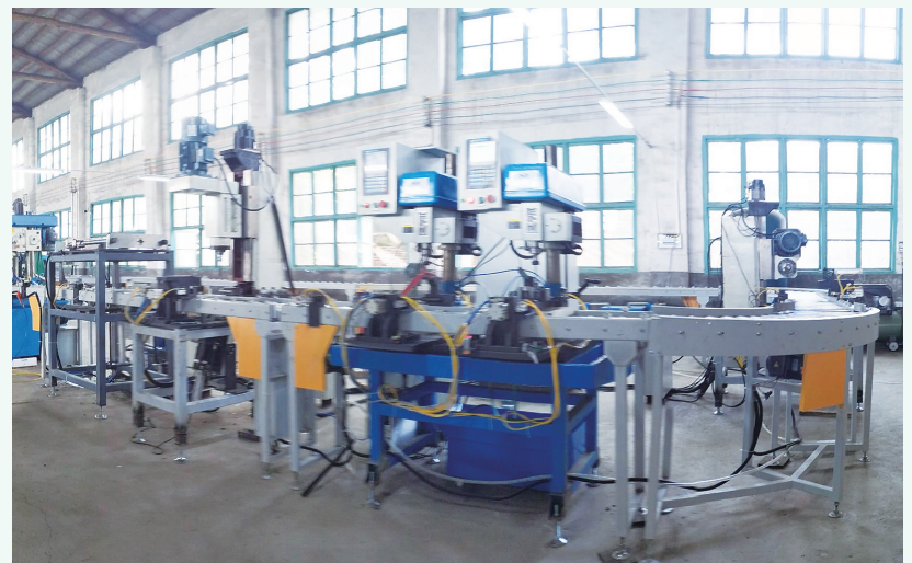
万理五金活口扳手全自动生产线
